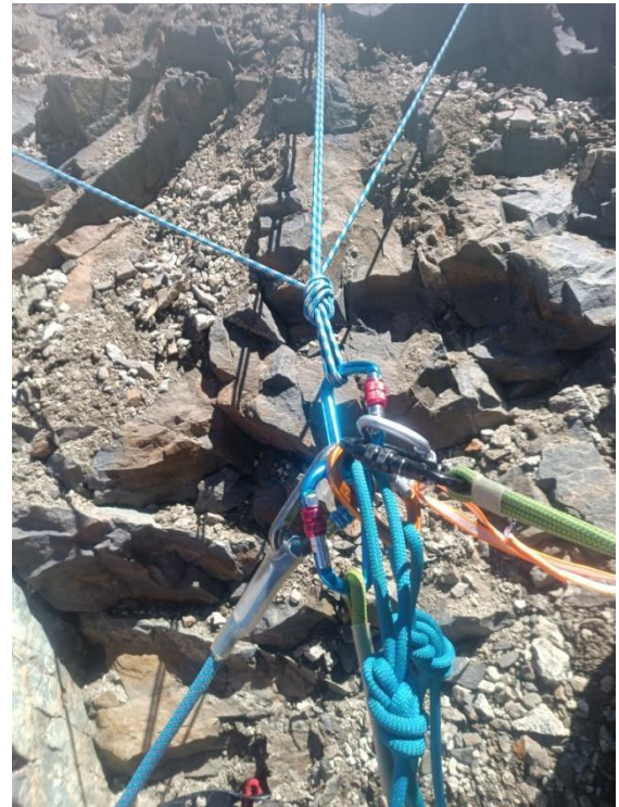
Фото 13.14 Станция на закладных элементах
